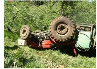
As estruturas de proteção são obrigatórias nos tratores matriculados após 1 de janeiro de 1994, devendo ter marcação CE desde 1996. A certificação do trator é obrigatória (incluindo-se a estrutura de proteção) depois de 29 de dezembro de 2009.
